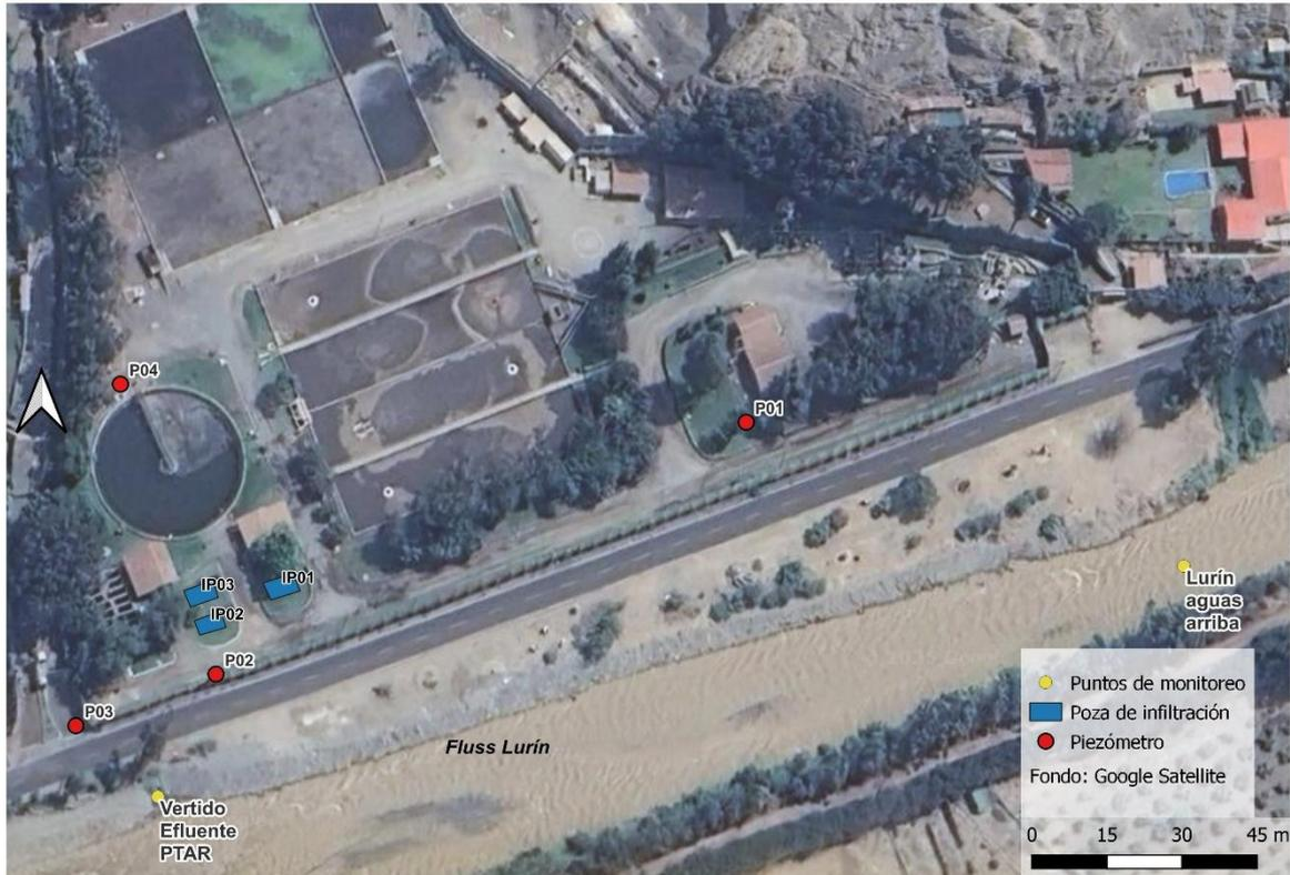
Figura 42: Puntos de medición de la conductividad eléctrica (CE)
