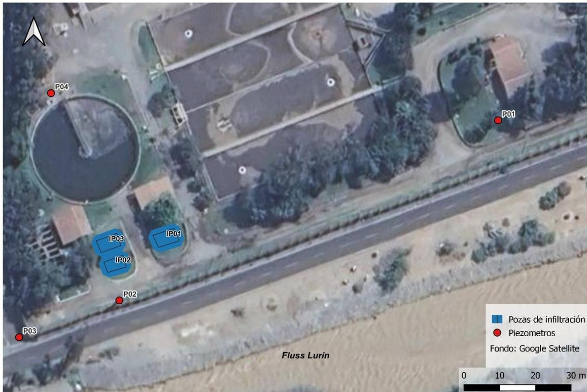
**Figura 20:** Ubicación de los piezómetros y de las pozas de infiltración, PTAR Cieneguilla
