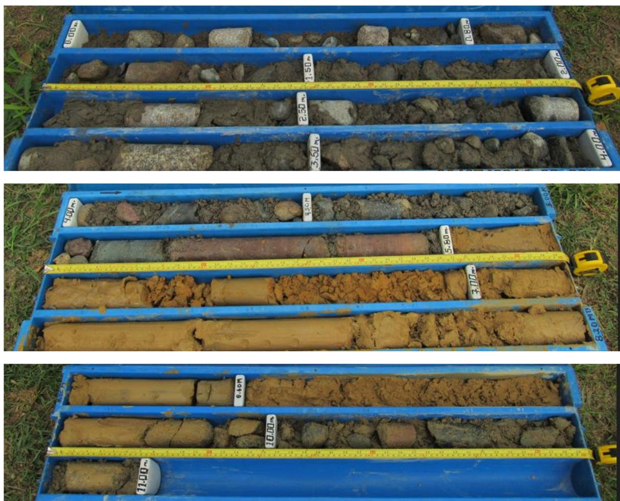
**Figura 17:** Testigos de perforación diamantina en el punto P02
