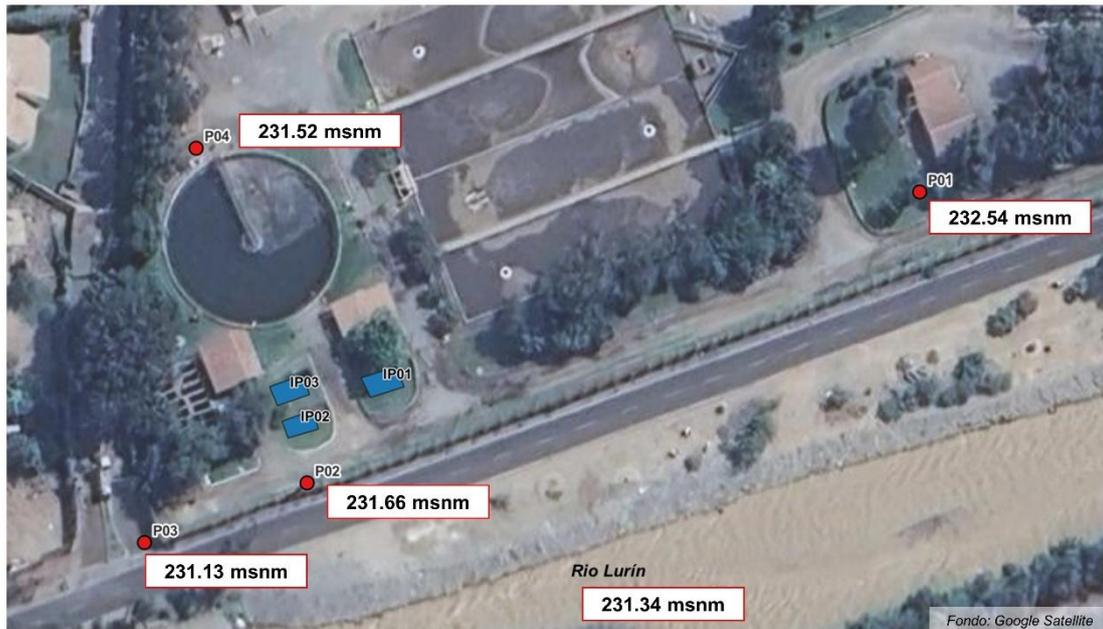
**Figura 27:** Nivel de agua en reposo determinado el 13.07.2023 en msnm
