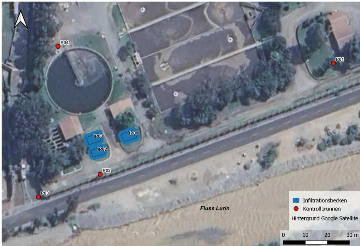
**Abbildung 20:** Position der Kontrollbrunnen (P01-P04) und der Infiltrationsbecken (IP01-IP03), Kläranlage Cieneguilla
