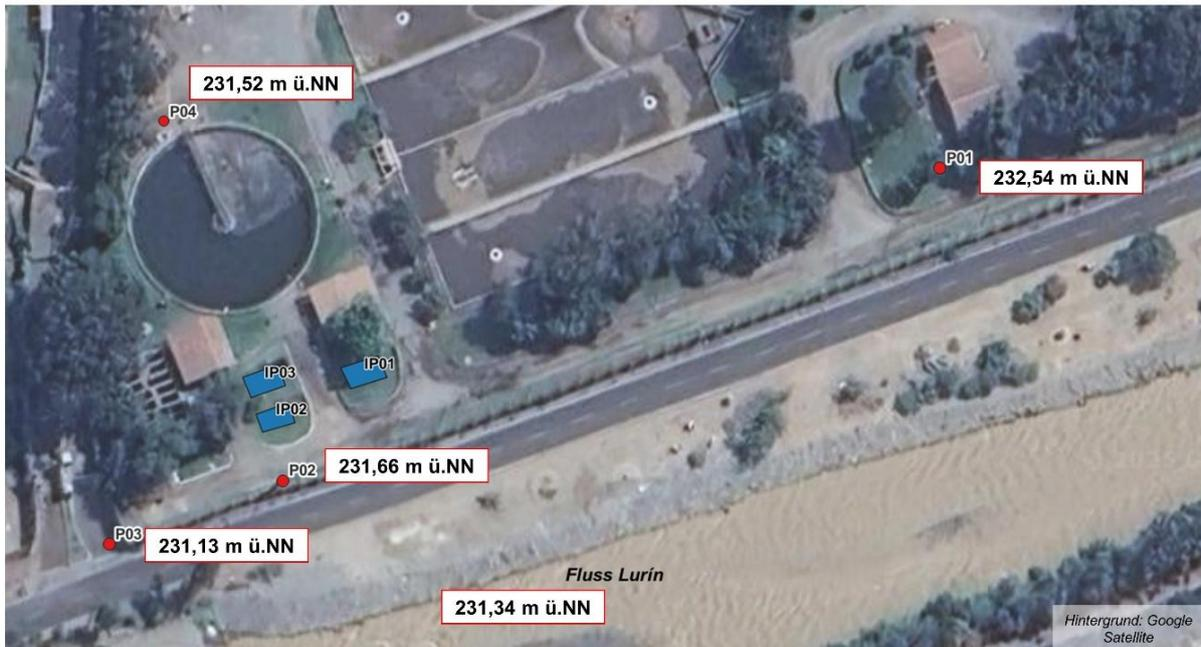
**Abbildung 27:** Am 13.7.2023 ermittelte Ruhewasserspiegel in m ü.NN
